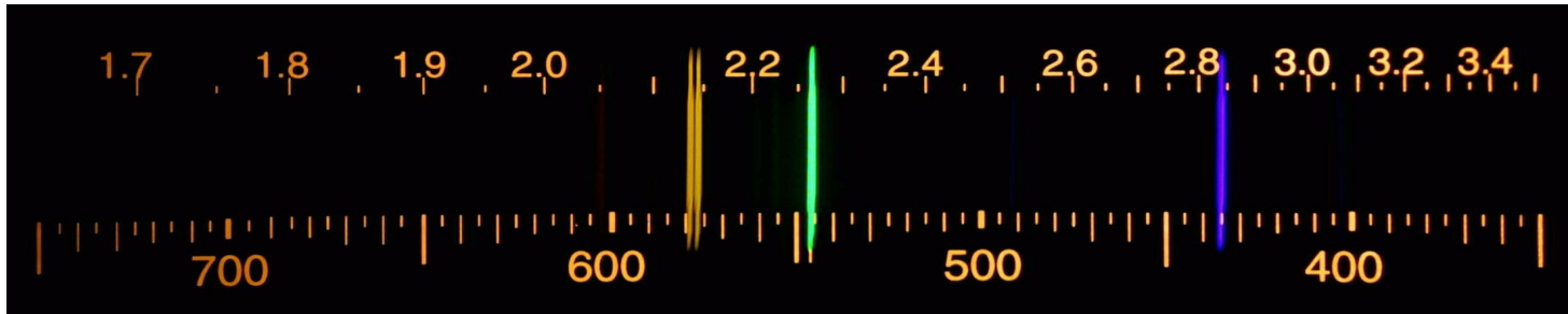
La excitación de un gas le hace emitir radiación, pero solo emite en ciertas longitudes de onda. Es su espectro de emisión, característico de cada sustancia
