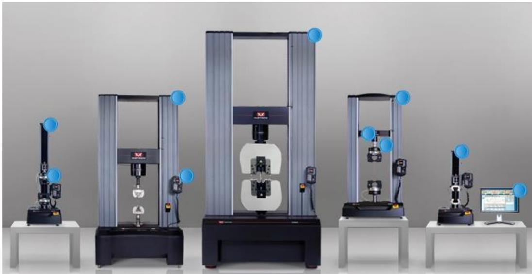
Se utiliza el **ensayo de tracción** para determinar la resistencia a la tracción de varios materiales desde metales hasta plásticos. Estos sistemas de ensayo de tracción utilizan varias tecnologías para usar una gama de fuerzas de tracción. Se puede usar fuerzas de tracción estándares con un instrumento de ensayo de tracción electromecánico estática. En este laboratorio se utilizara la norma ASTM D638 para materiales plásticos.
