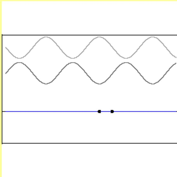
Cada punto de la cuerda simplemente oscila con una misma frecuencia  $\omega$ . Es decir realiza un movimiento armónico simple con frecuencia  $\omega$ .
