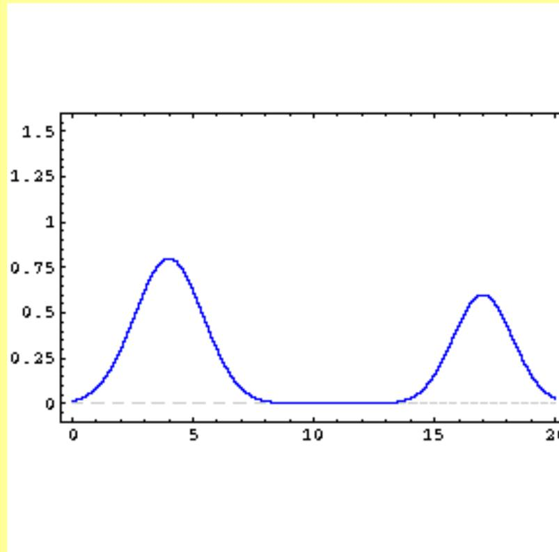
Observamos que los dos pulsos se atraviesan sin deformarse y el desplazamiento neto de los puntos en la cuerda es simplemente la suma de los dos desplazamientos individuales.
