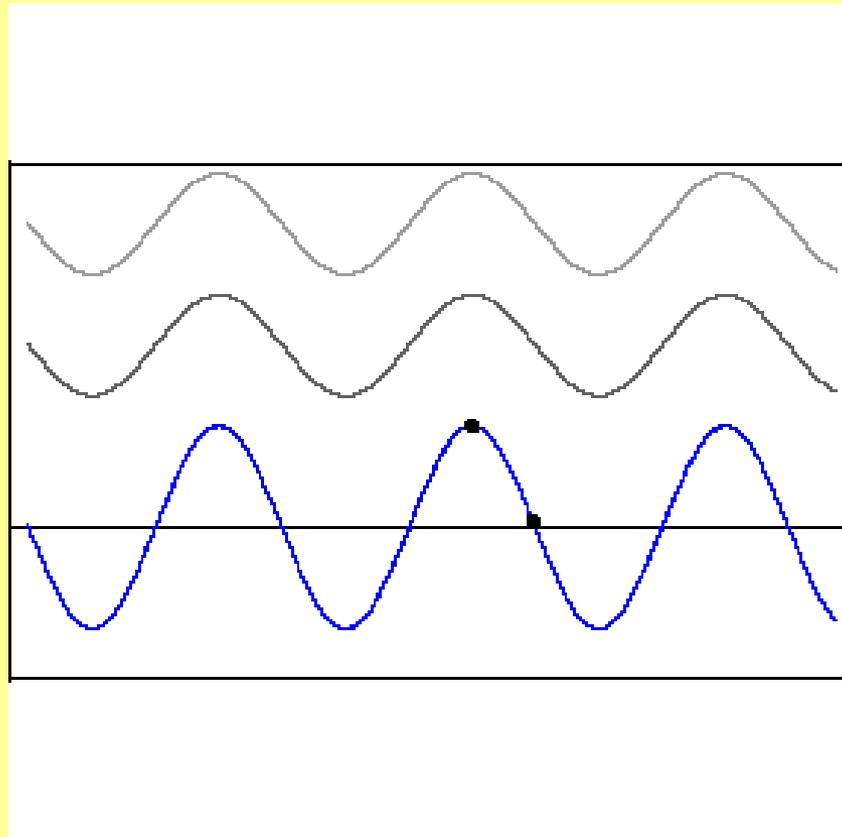
En esta animación se consideró una diferencia de fase que cambia con el tiempo, de manera de observar los diferentes tipos de interferencia.
